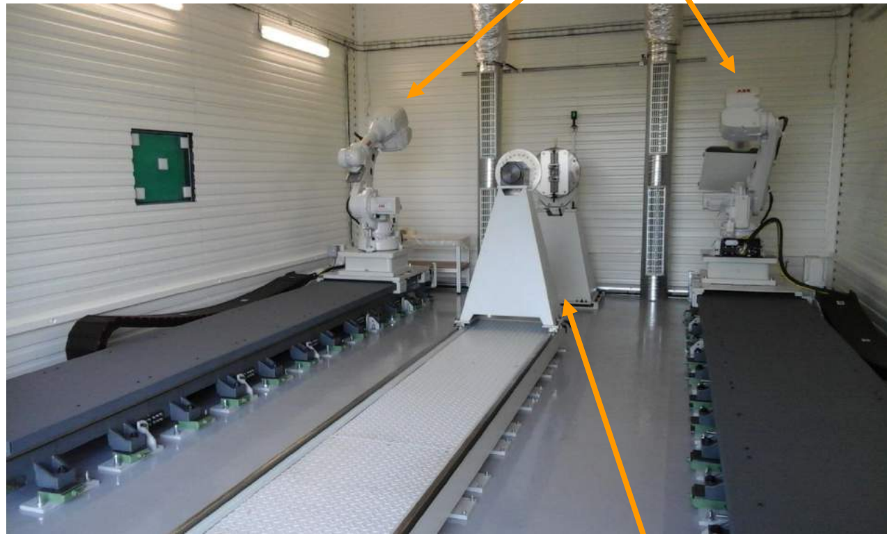
Un positionneur composé de 2 poupées à tête rotative
